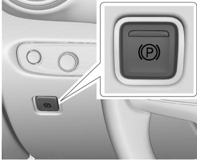
فرامل الركن الكهربائية (EPB) دائماً ما تكون قابلة للربط، حتى مع ضبط المركبة على وضع إيقاف التشغيل. إذا كانت الطاقة الكهربائية غير كافية فلن يمكنك ربط فرامل اليد الكهربائية أو تحريرها. لمنع استنزاف البطارية، تجنب الدورات المتكررة غير الضرورية لفرامل الركن الكهربائية (EPB).
