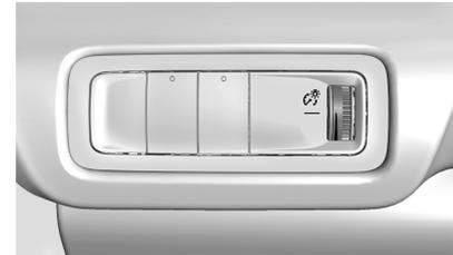
تعمل هذه الميزة على ضبط سطوع جميع عناصر التحكم المضاءة. يوجد مفتاح التحكم في إضاءة لوحة أجهزة القياسات بجوار مفتاح التحكم في المصابيح الخارجية.
