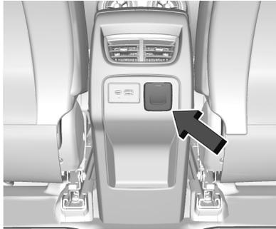
يوجد منفذ الكهرباء في مؤخرة الكونسول المركزي.
