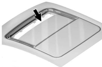
قد تتجمع الأتربة والنفائيات على سداة فتحة السقف أو في مسارها. ويمكن أن يسبب ذلك مشكلة عند تشغيل فتحة السقف أو قد يسبب ضجيجًا. كما يمكن أيضًا أن يسد نظام تصريف المياه. افتح فتحة السقف بشكل دوري وقم بإزالة أي عوائق أو نفائيات متباعدة. امسح سداة فتحة السقف ومنطقة سد السقف باستخدام قطعة فماش نظيفة أو إسفنجة طرية مع الماء. لا تقم بإزالة الشحم عن فتحة السقف.
