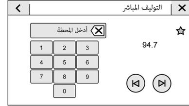
يمكنك الوصول إلى "Direct Tune (المواصفة المباشرة)" من خلال لمس **|||** على شاشة نظام المعلومات والترفيه لإظهار لوحة المفاتيح الرقمية. انتقل عبر جميع الترددات باستخدام الأسمم الموجودة على الجانب الأيمن من شاشة Direct Tune (المواصفة المباشرة). أدخل مباشرةً على أي محطة باستخدام لوحة المفاتيح. عند إدخال محطة جديدة، تعرض المعلومات عن المحطة بالجانب الأيمن. سوف يتم تحديث هذه المعلومات مع كل تردد جديد صحيح. المس **☆** لحفظ المحطة في المفضلة.
