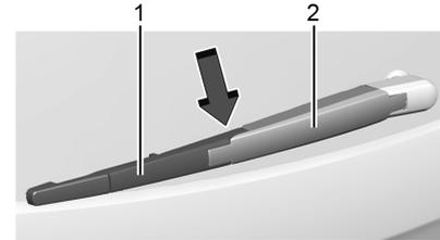
٢. أثناء إمساك بذراع الماسحة، اضغط للأسفل عند طرف تجميع شفرات الماسحة (1) حيث يتم توصيله بذراع الماسحة (2) من أجل نزع التجميع من ذراع الماسحة.
