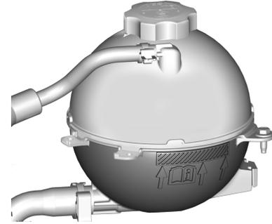
تحقق لمعرفة ما إذا أمكن رؤية محلول التبريد في خزان اندفاع محلول التبريد. وإذا كان محلول التبريد داخل خزان اندفاع محلول التبريد يغلي، فلا تقم بأي شيء حتى يبرد. راجع ارتفاع درجة حرارة المحرك بصورة مفردة ٢٦٥. يوجد خزان اندفاع سائل التبريد في حجرة المحرك جهة سائق المركبة. راجع نظرة عامة على غرفة المحرك ٢٥٣.
