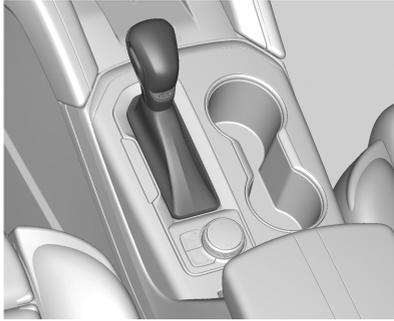
P (ركن) : يُستخدم هذا الوضع في قفل العجلات القائدة. استخدم هذا الوضع عند بدء تشغيل المحرك لأن المركبة يتعذر تحريكها بسهولة.
