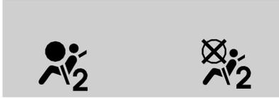
عند بدء تشغيل المركبة، يضيء مؤشر حالة الوسادة الهوائية للراكب الرموز التي تشير إلى التشغيل وإيقاف التشغيل. وذلك لعدة ثوانٍ كعملية فحص للنظام. ثم بعد عدة ثوانٍ، سيقوم مؤشر الحالة بإضاءة رمز التشغيل أو رمز إيقاف التشغيل لإعلامك بحالة الوسادة الهوائية الأمامية للراكب الأمامي الجالس على الطرف.
