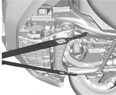
السيارة مزودة بنقاط تثبيت محددة بلزم استخدامها بواسطة موفر خدمة السحب. ويمكن استخدام هذه الفتحات لسحب السيارة من طريق مسطح إلى ظهر ناقلة السيارات ذات السطح المستوي.
