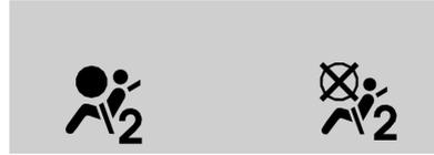
وسيكون رمزا التشغيل وإيقاف التشغيل مرتين أثناء فحص النظام. عند انتهاء فحص النظام فسوف يظهر إما رمز التشغيل أو رمز إيقاف التشغيل. راجع مؤشر حالة الوسادة الهوائية للراكب ١٠١.
